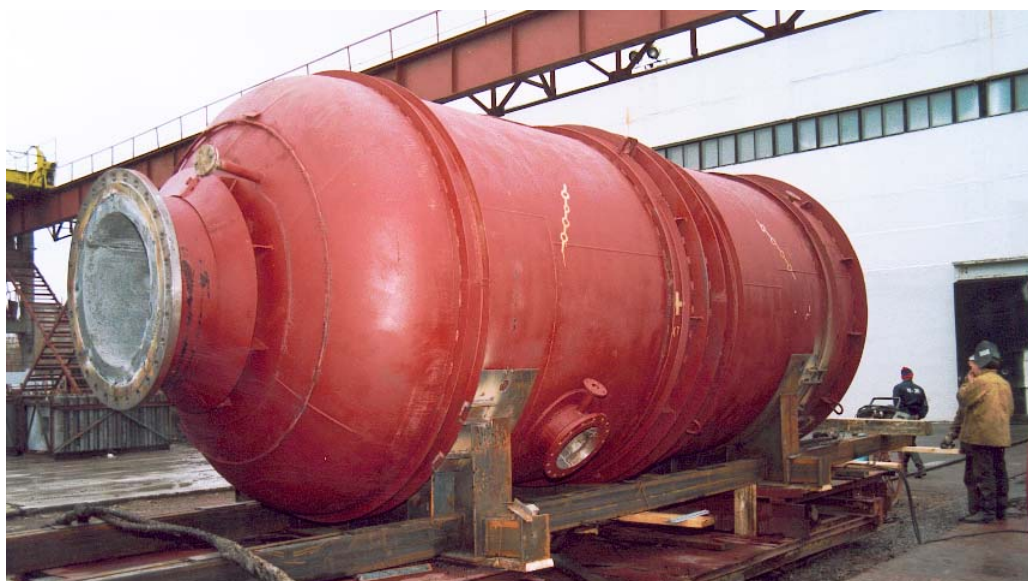
Рисунок 2. Футерованная огнеупорным бетоном топка установки каталитического крекинга Г 43-107 на отгрузке.
