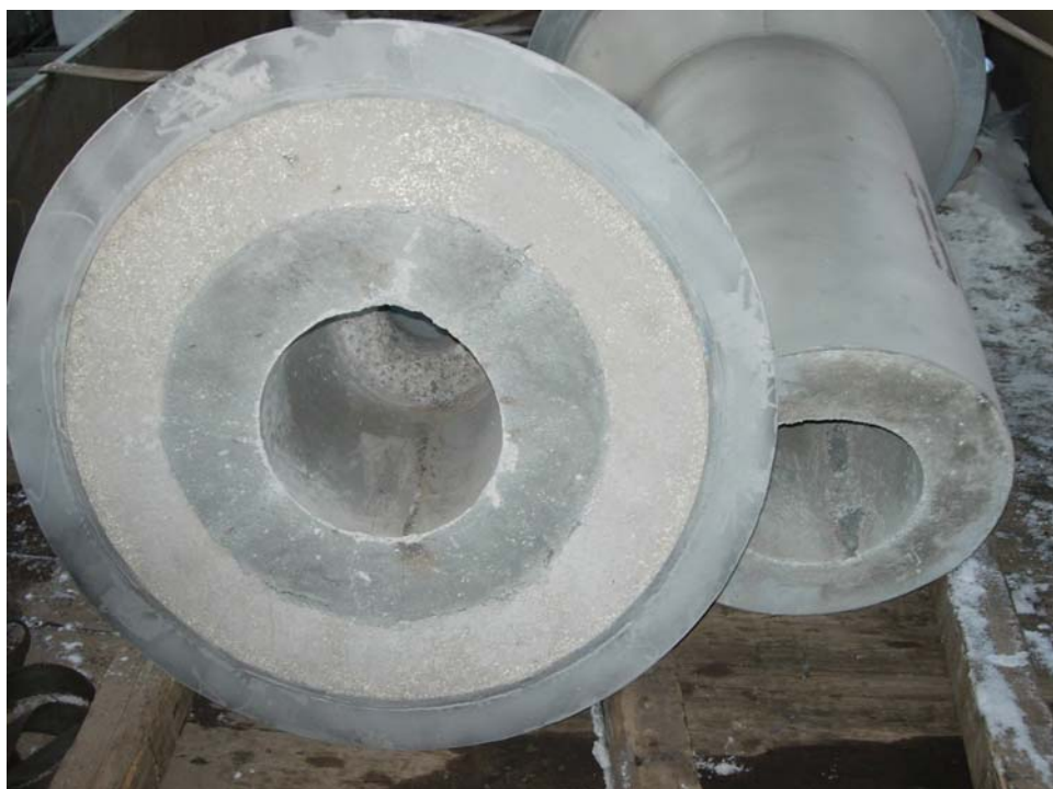
Рисунок 3. Вкладыши топки установки элементарной серы.
